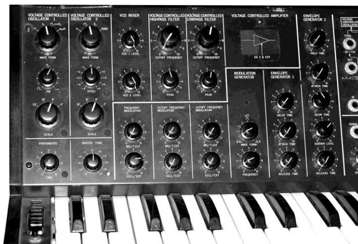
**KBD** = Keyboard/Tastatur. Diese Tastatur erzeugt bei Niederdrücken einer Taste eine Steuerspannung, die am OSZ eine Frequenz einstellt.
