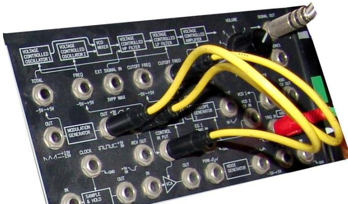
Abb. 10.7 Das Patchboard des Synthesizers von Abbildung 10.6
