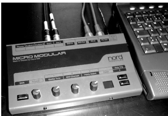
2. Auslagerung rechnerintensiver Vorgänge. Bei Nord-Leads „Micro Modular“ befindet sich die gesamte digital-analog-Wandlung und Klangberechnung in einem spezialisierten externen Gerät. Der PC übernimmt nur die elegante und übersichtliche Zusammenstellung der Moduln und das virtuelle Drehen der Regler. Als Verbindung zwischen externem Gerät und PC genügt dann sogar das langsame MIDI. Die Soundcard des PC hat nichts zu tun, der (gute) Klang kommt aus dem externen Gerät. Siehe Abbildung links!
